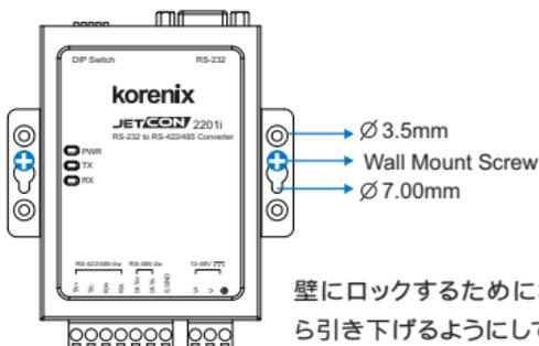
壁にロックするためにねじを締めた後にユニットを上から引き下げるようにしてマウントしてください。
