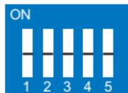
在一个空闲的multi-drop RS-485网络中，所有节点均为监听(接收)模式。在此情况下，网络中没有活动的驱动。无任何驱动的网络，线路的状态是未知的。JetCon 2201提供偏压电阻选择功能，保持RX+和RX-有200mV电压。如果网络节点多达32个，首节点和末节点需要开启偏压电阻保持RX+/-的最后位元状态。
