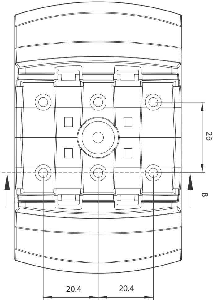
**Figure 1-8: Module Stand Top View**
