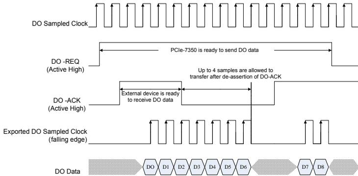
**Figure 3-21: DO Burst Handshaking Timing Diagram**
