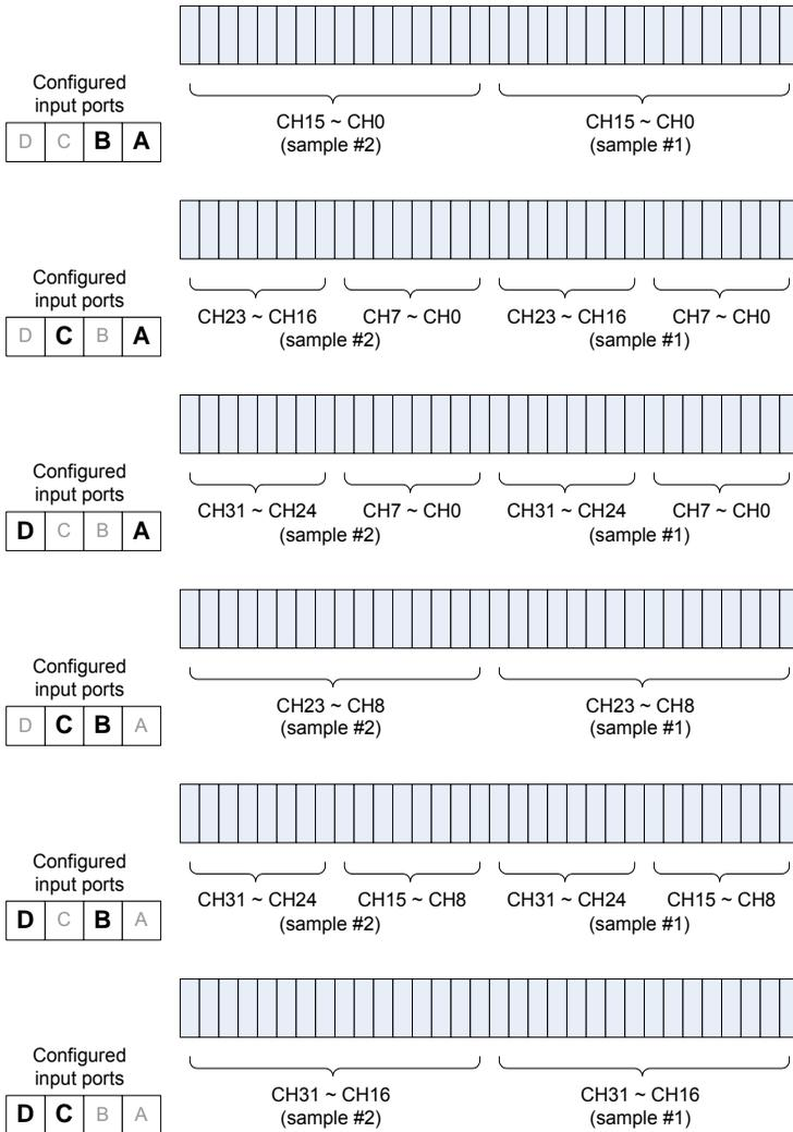
**Figure 3-3: DI Row Data Mapping for 16 Bits Data Width**
